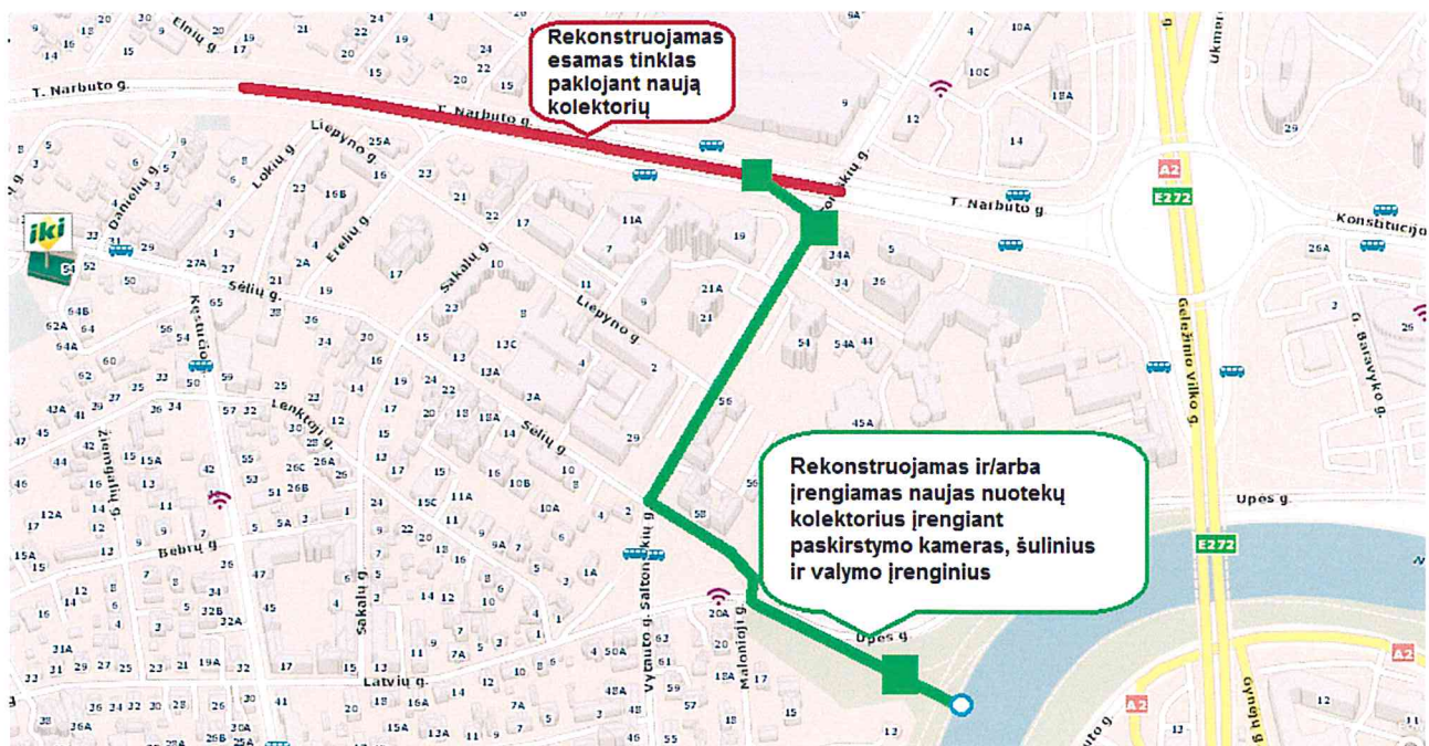
3 pav. Atnaujinta objekto „T. Narbuto - Saltoniškių gatvių lietaus nuotekynės rekonstravimo, valyklos ir monitoringo sistemos įrengimo darbai“ darbų schema
